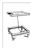
**Erdung:** Die Bodendosen müssen fachgerecht installiert und montiert werden. Alle metallisch leitenden Teile müssen miteinander verbunden und an einem Punkt zusammengeführt werden. Ein Erddraht ist beim Unterteil der Bodendose bereits
