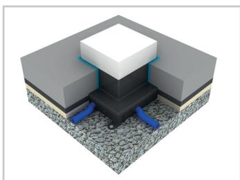
**4.** Evtl. Stellstreifen abschneiden. Einbau-Box mit einem Messer bündig Unterlagsboden rundum abschneiden.
