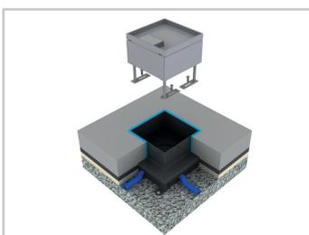
**6.** Nivellierschrauben in die Bodendose einschrauben. Bodendose in die Aussparung einlegen. Die Nivellierschrauben an den vorgesehenen Stellen anschrauben.
