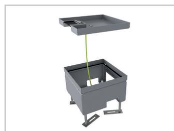
**Erdung:** Die Bodendosen müssen fachgerecht installiert und montiert werden. Alle metallisch leitenden Teile müssen miteinander verbunden und an einem Punkt zusammengeführt werden. Ein Erddraht ist bereits vormontiert und muss nur noch mit dem Unterteil und Deckel verbunden werden.
