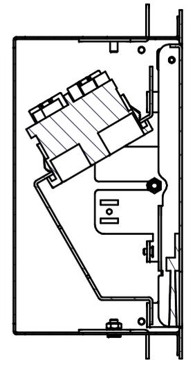
Befestigungswinkel für Leichtbauwände
